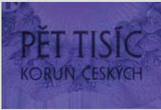
text PĚT TISÍC KORUN ČESKÝCH does not fluoresce
